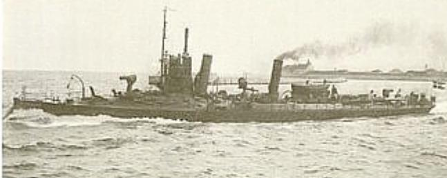
"Torpedobåt er et hurtiggående, litet kriegsfartøy som fører torpedovåpen og har fremdriftsmaskineri drevet med damp. De første dampkjelene i torpedobåter var kullfyrt. Senere ble de oljefyrt.. Torpedovåpenet ble utviklet fra slutten av 1860-tallet og utviklingen av våpenet og båtene skjedde parallelt fra dette tidspunkt og frem mot andre verdenskrig. Da overtok torpedobåter drevet med bensin- og dieselmotorer. Disse båtene fikk betegnelsen motortorpedobåter (MTB)."
