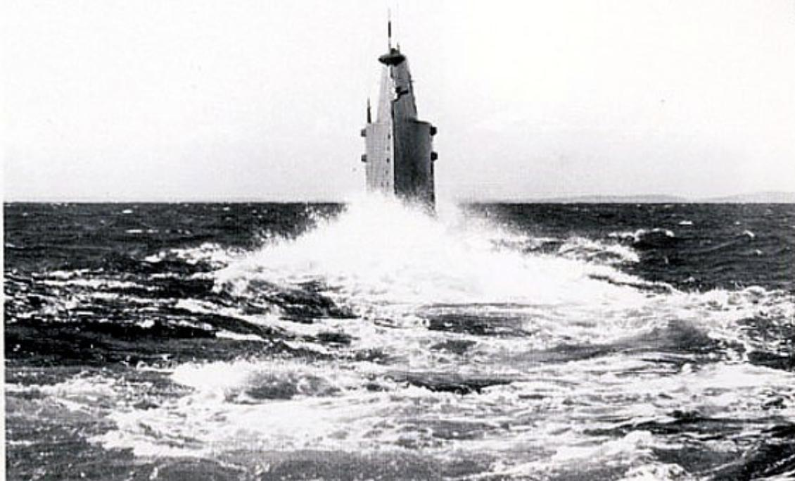
Draken var utrustad med stor propeller härav den stora vattenkaskaden.
